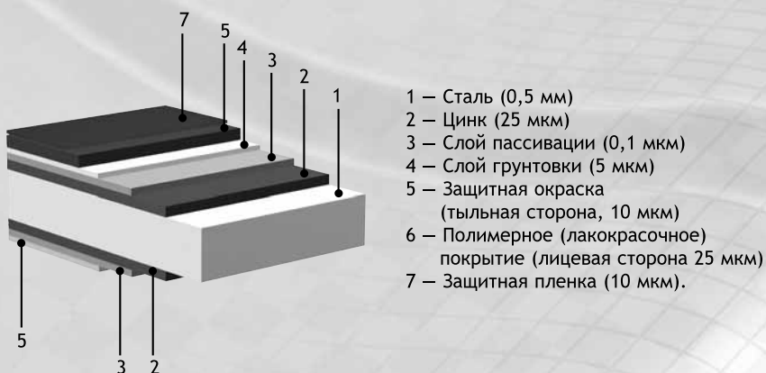
Рис. 1. Структура стального листа с полимерным покрытием
